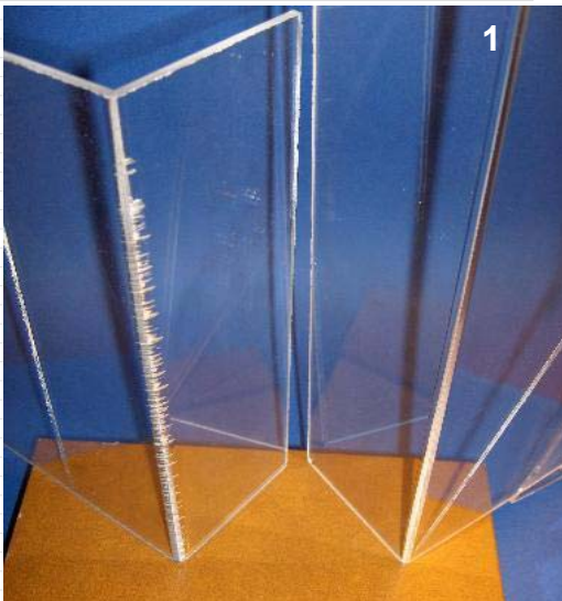
Photo 1 : à droite, pliages après rainurages d'Altuglas® Essential. Après 3 mois, Altuglas® Essential reste indemne de micro-fissuration.
