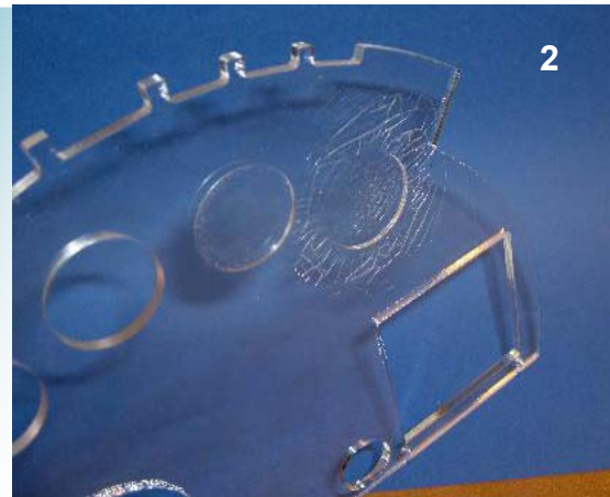
Photo 2 : Micro-fissurations (crazing) après défonçage et polissage à la flamme d'une pièce PMMA CN standard et après vaporisation d'un jus de parfum (partie droite).
